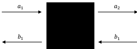
Figur 3.3: En tvåports-krets och de olika vågor som kan utgå från en sådan.
