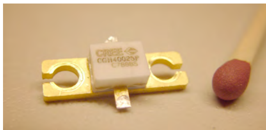
Figur 4.1: Cree's CGH40025F GaN HEMT, den valet föll på.
